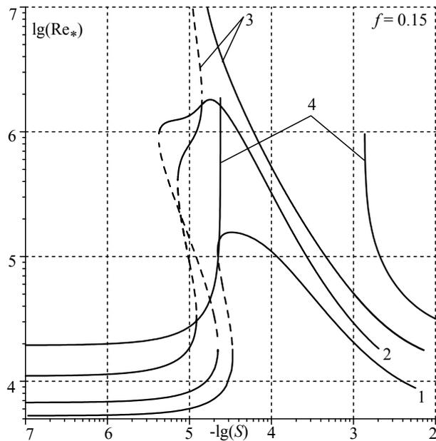
Рис. 1. Зависимость критического числа Рейнольдса от параметра  $S$  при  $\rho = 0.15$ .
