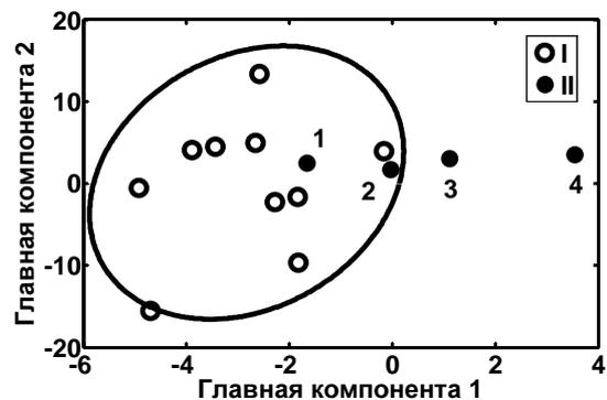
Рис. 2. Влияние искажений голосового сигнала на идентификацию. I – исходные сигналы, II – искаженные сигналы. Коэффициент искажения: 1 –  $K = 0,15$ ; 2 –  $K = 0,20$ ; 3 –  $K = 0,25$ ; 4 –  $K = 0,30$
