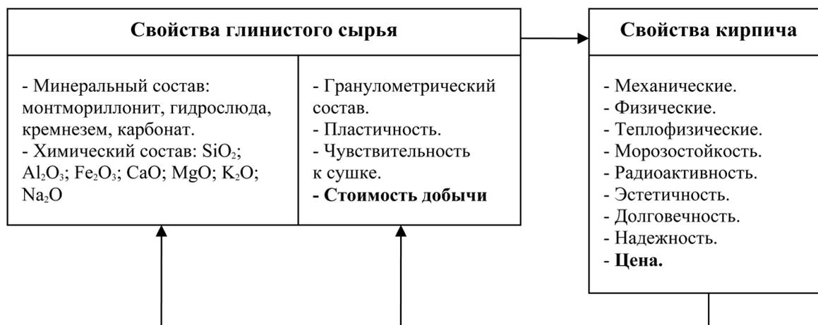
Схема комплексной оценки качества глинистого сырья и готового керамического стенового материала – кирпича
