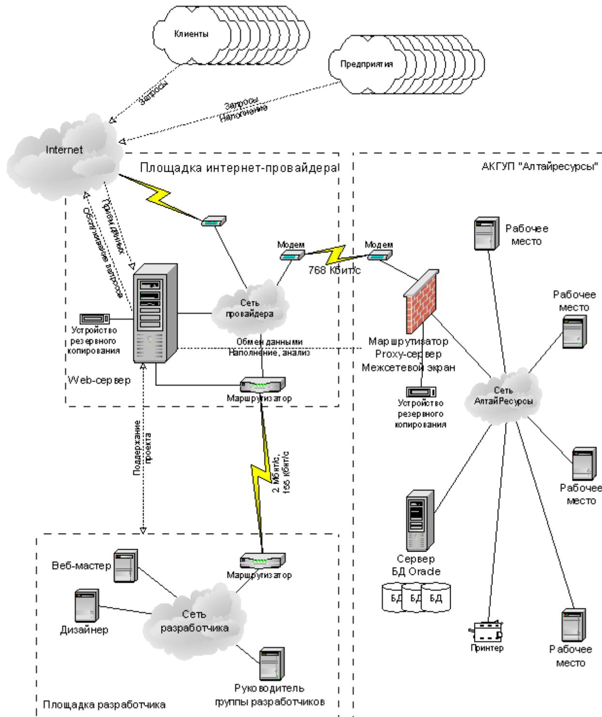
Рис. 2. Схема сетевого взаимодействия в подсистеме сопровождения товарных рынков ИАС Алтайского края в период функционирования системы
