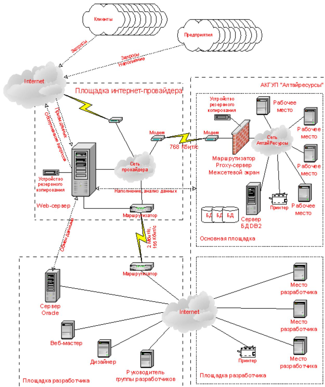
Рис. 1. Схема сетевого взаимодействия в подсистеме сопровождения товарных рынков ИАС Алтайского края на период разработки проекта
